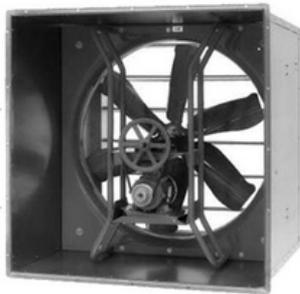
Esta serie cuenta con dos opciones de acoplamiento, transmisión directa con banco portafiltros hasta con dos etapas de filtrado y transmisión por poleas y bandas con una sola etapa de filtrado. Hélices de acero al carbón. WXT opción transmisión poleas-bandas, ofrece cuatro tamaños con diámetro nominal de 800, 1000, 1250 y 1500 mm. Aplicaciones: bodegas, gimnasios, talleres, y fábricas.
