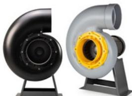
Conjunto carcasa en una sola pieza fabricada en polipropileno, turbina tipo álabes curvos adelantados fabricada por inyección de polipropileno, motores estándar cerrados, bajo nivel sonoro, diseño compacto que facilita la instalación.
